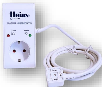
Lekkasjestopper med strømnett Lekkasjestopperen registrerer signal fra sensortapen og forsyner magnetventilen med strøm. Den har eget strømuttak som automatisk kutter strømmen ved en eventuell lekkasje. NB! Dette uttaket er ikke for tilkobling av varmtvannsbereder jf. NEK 400 – Norsk Elektronisk Komite (NEK)
